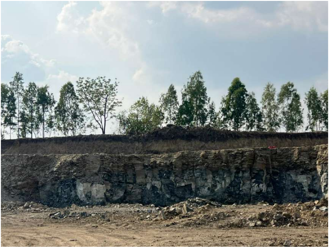
รูปที่ 15 ลักษณะชั้นดินและชั้นหินปะชอลต์บริเวณประทานบัตรที่ 33638/16367 ด้านทิศใต้ ของพื้นที่คำขอประทานบัตร
